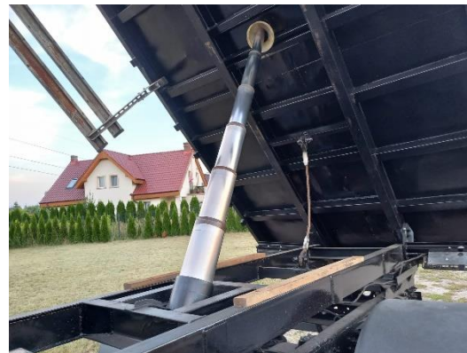
brak wycieków siłowników po regeneracji
