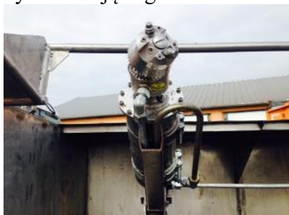
Opeja: głowica wirująca z 3 dyszami
