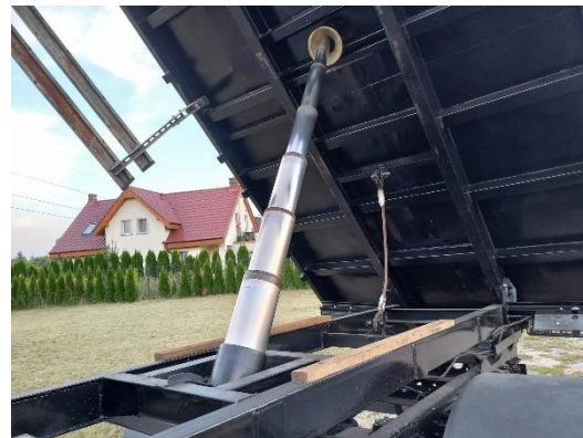
brak wycieków siłownik po regeneracji
