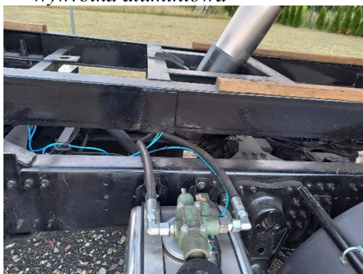
Nowy zbiornik hydrauliczny
